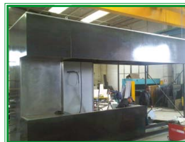
GUARDIANA NOTTURNA IN FERRO IN FASE DI REALIZZAZIONE IN OFFICINA
