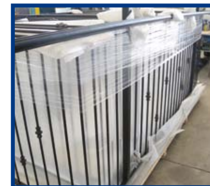
IMBALLAGGIO DEI BALCONI VERNICIATI
