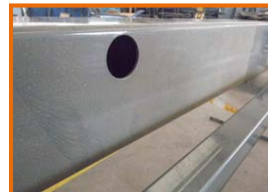
PREDISPOSIZIONE PER MOTORIZZAZIONE ALLOGGIO FOTOCELLULE
